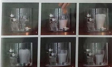
**Längenausdehnung durch Erwärmung**
